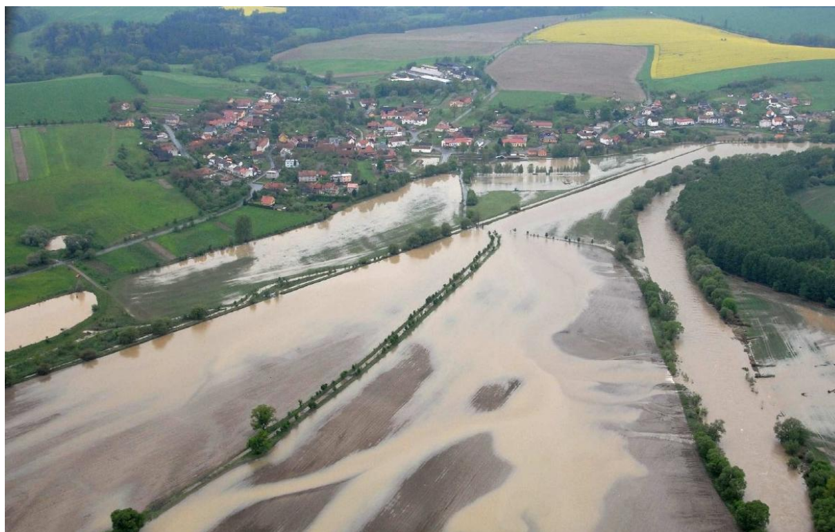
Obr. A.3.b-2: Letecký snímek obce Ústí z května 2010. Vpravo zaplněné koryto Bečvy, v popředí prostor bývalého rybníka Otrž. Napřímený Nihlovský potok probíhá diagonálně středem snímku, meliorační svodnice podél asfaltové cyklostezky je do něj zaústěna zprava (Povodí Moravy, 2010)
